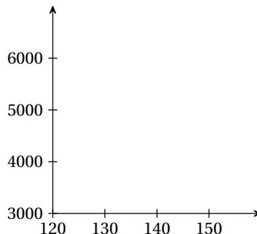
`axexo.pos(grad,val)`, `axeyo.pos(grad,val)`, `axeso.pos(grad,val)` macros identiques aux précédentes sauf pour l'étiquette correspondant à l'intersection des axes qui est toujours dessinée.
